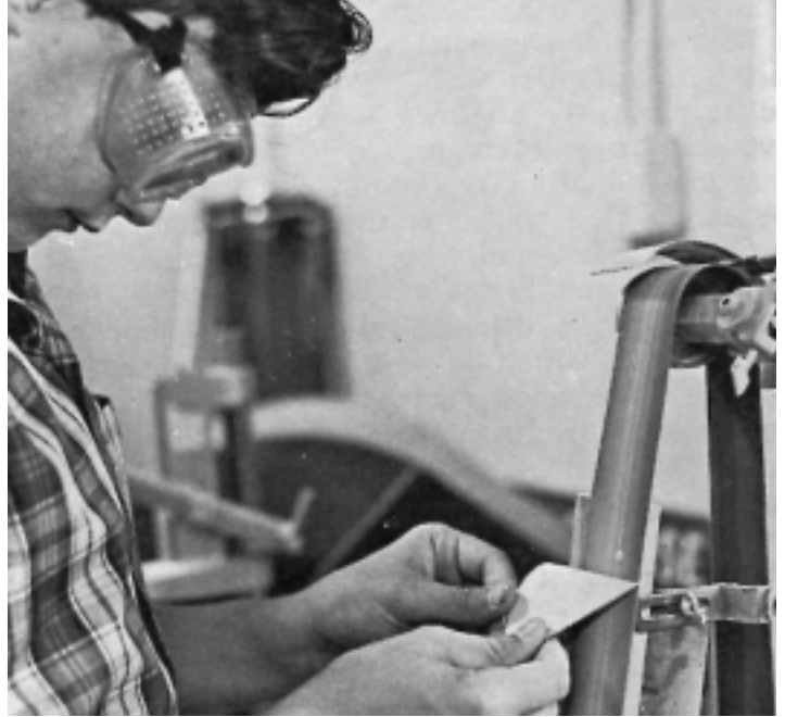
Gelişmiş roketçi atölye zımpara makinesinde özel yarış için dizayn edilmiş yüzgeç kanadı yapmaktadır.
