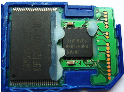
Şekil 1.2 SD kartın iç yapısı.
