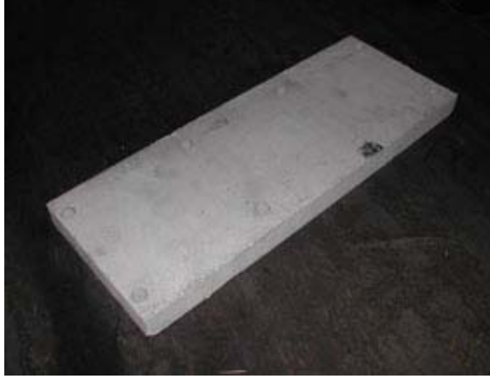
Şekil 5. Kalıp içi kullanılan asbest plaka
