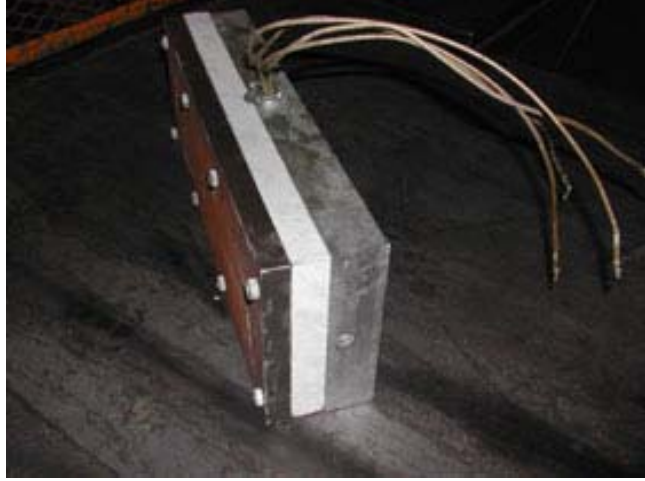
Şekil 6 Kalıbın asbest plaka ile monte edilmiş hali
